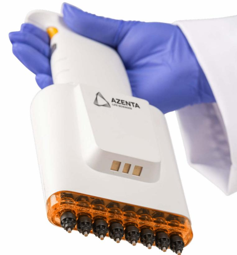
Azenta’s Semi-Automated Handheld Screw Cap Decapper
